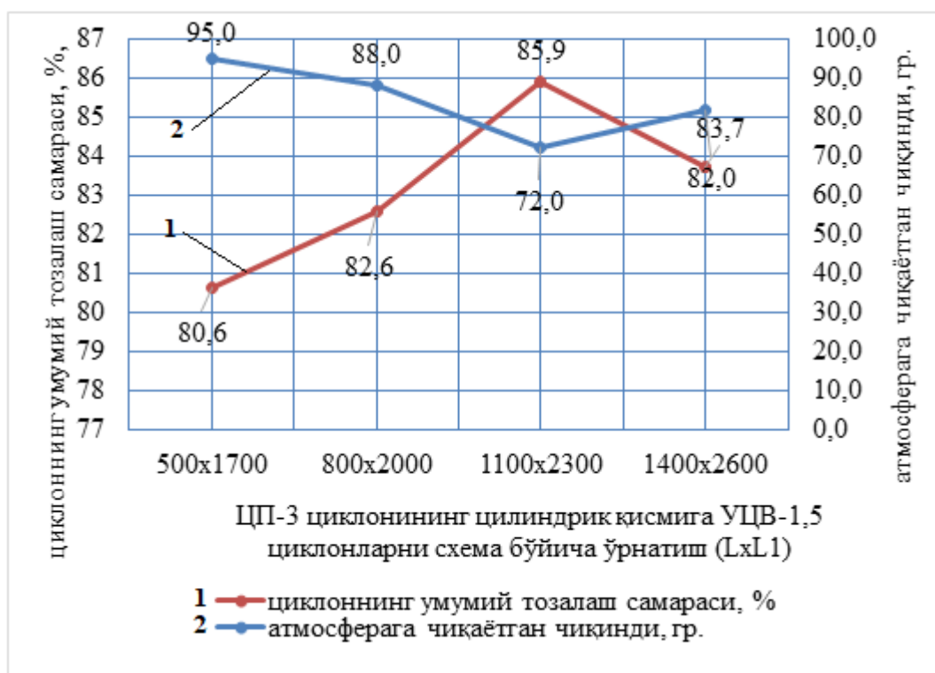
2-расм. Циклонларни ўрнатиш схемасини тозалаш самарасига ва атмосферага чиқадиған толали материалларга таъсири.
