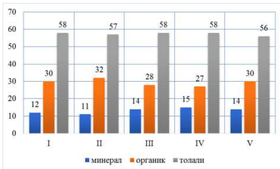
3-расм. Чигитни линтерлаш жараёнидан ажралаётган чиқиндиларнинг пахта саноат навлари бўйича фракцион таркиби
