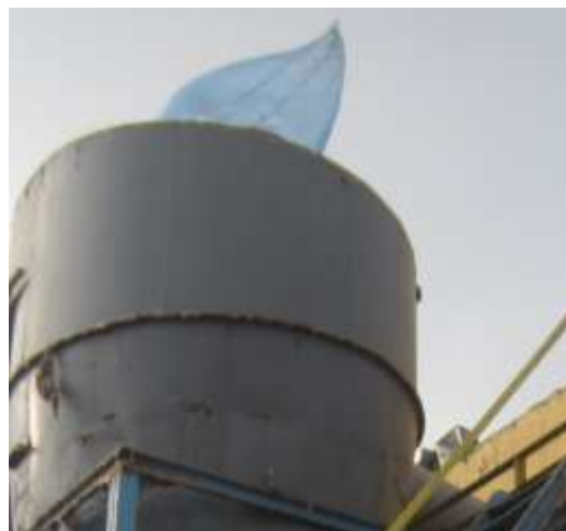
1-расм. Циклоннинг атмосферага чиқиш туйнугига фильтрни ўтнатиш.
