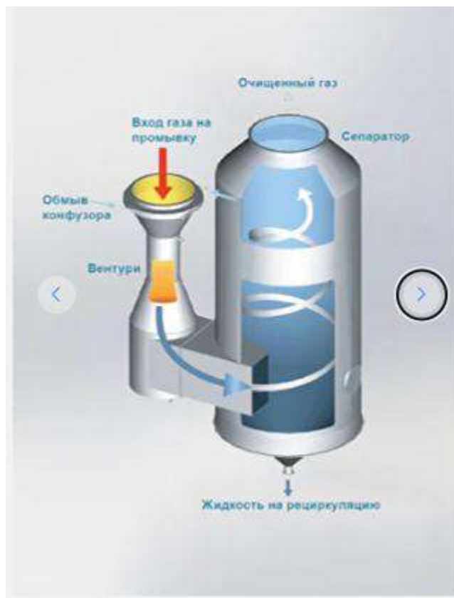
1-Rasm. Halqasimon aloqa kanaliga ega Venturi skrubberi
