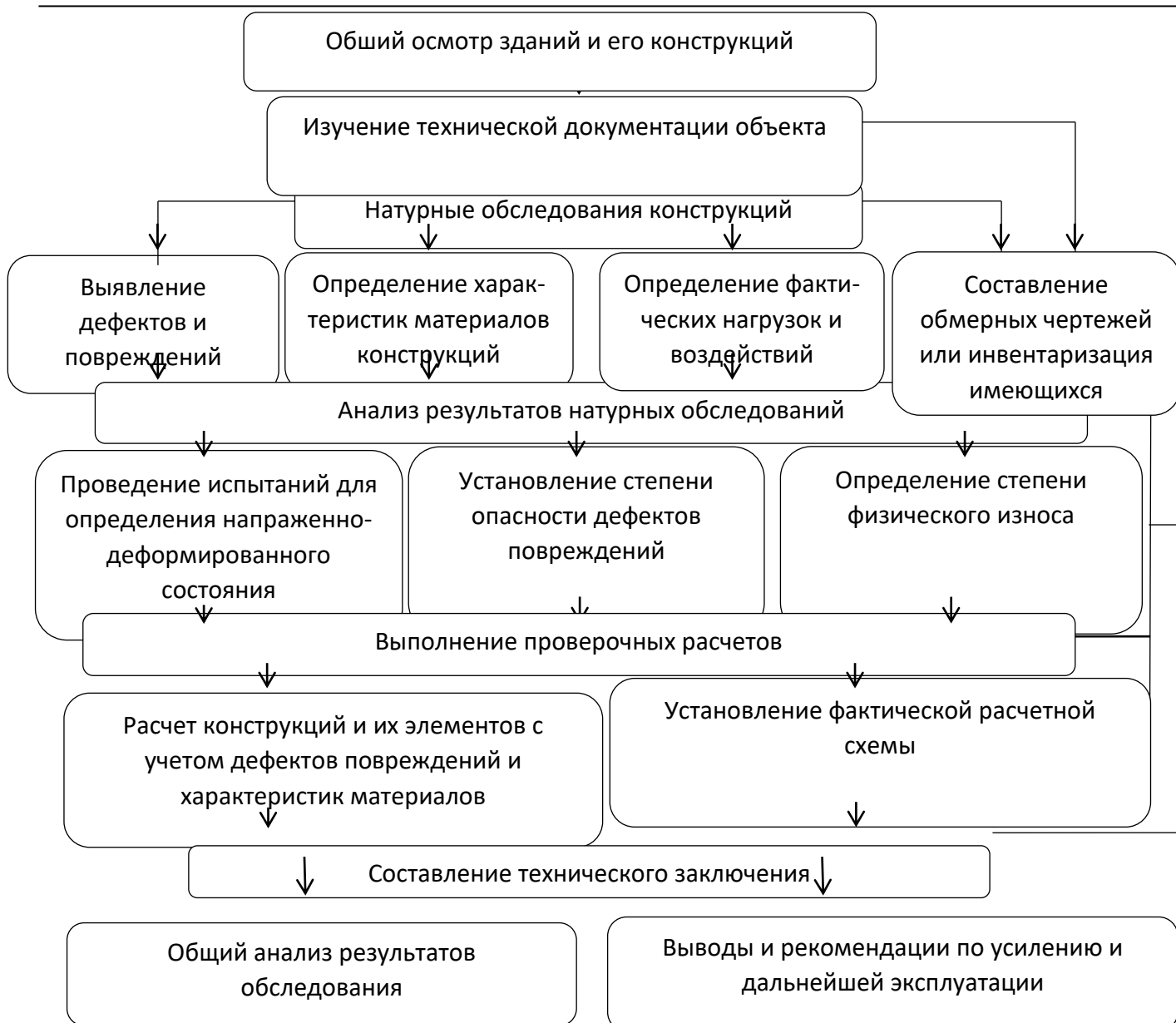
Рис. 2. Последовательность работ по обследованию конструкций зданий.
