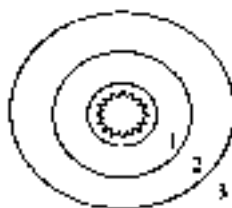
Рис. 1. Напряженно-деформированное состояние массива вокруг очага камуфлетного взрыва скважинного заряда ВВ
