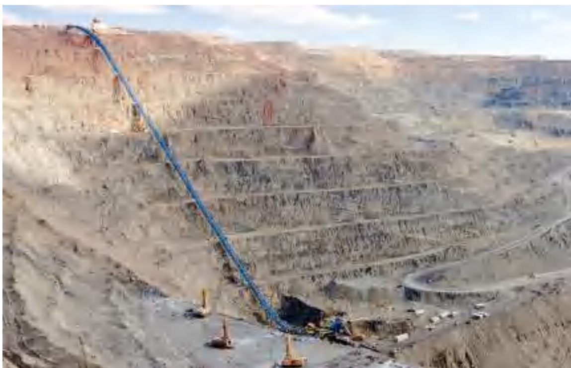
2-расм. “Мурунгов” конига ўрнатилган КНК-270 тик қия конвейери. ( www.ngmk.uz )
