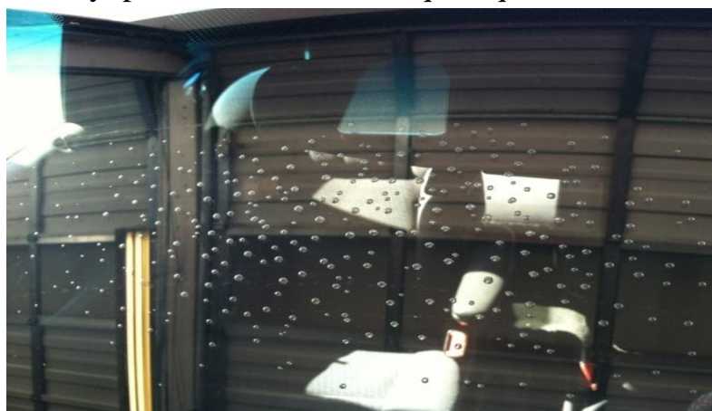
4-rasm. Vakuumlashda havoni yaxshi soʻrilmagandagi hosil boʻlgan nuqsonlar
