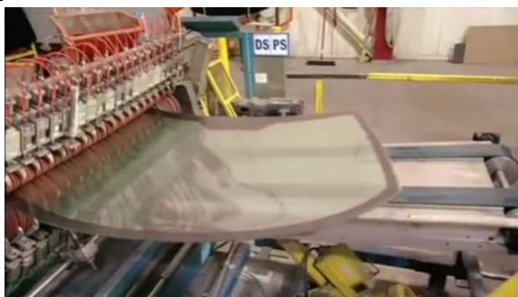
2-rasm. Avtomatik liniyada vakuumlash jarayoni
