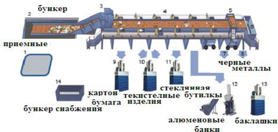
Рис 1: Структурное изображение устройства для разделения бытовых отходов.
