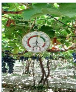
Хавонинг нисбий намлигини аниқлайдиган психрометр ва ташқи хаво хароратини аниқлайдиган термометр жихозлари.
