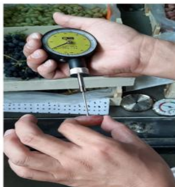
Uzum mevasini qattqlik darajasini aniqlaydigan penitrometr jixozini.
