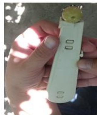
Uzum mevasini geometrik o‘lchamlari uchun shtangensirkul jixozida o‘lchash uslubi qo‘llanildi.
