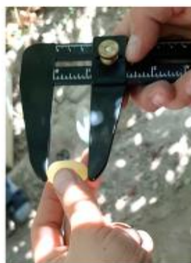
Uzum mevasini geometrik o‘lchamlari uchun shtangensirkul jixozida o‘lchash uslubi qo‘llanildi.
