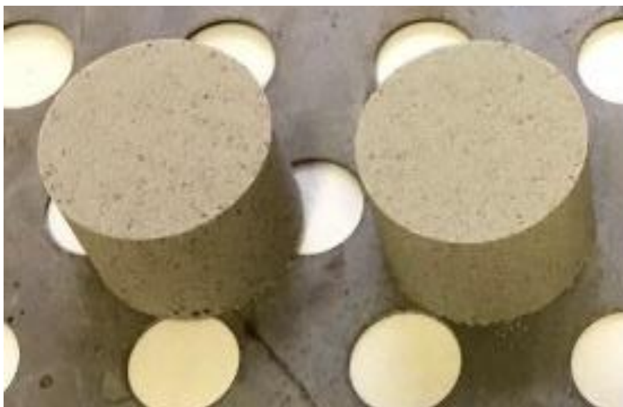
Рисунок 1 – Образцы для испытания газопроницаемости
