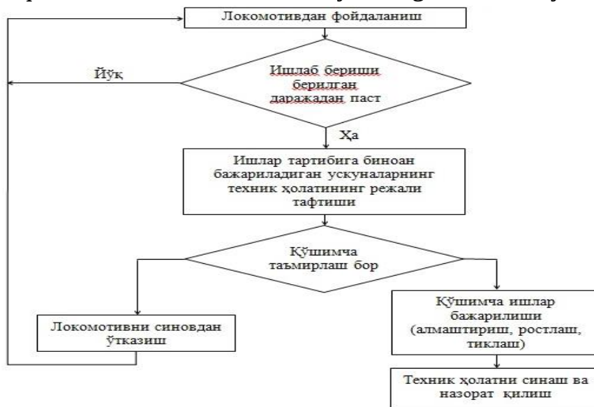
1.1-rasm. Rejali-oldini olish tizimi bo‘yicha texnik xizmat ko‘rsatish va ta‘mirlash sxemasi
