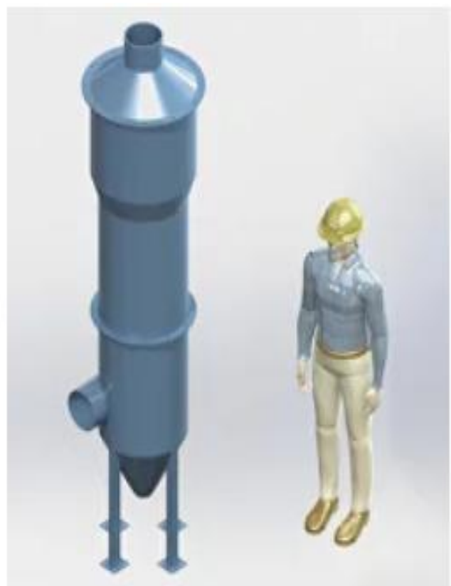
1-Rasm. Halqasimon aloqa kanaliga ega Venturi skrubberi
