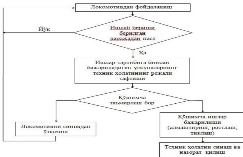
1.1-rasm. Rejali-oldini olish tizimi bo'yicha texnik xizmat ko'rsatish va ta'mirlash sxemasi
