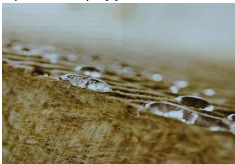
2-расм: Гидрофобизацияланган иссиқлик изоляция плитаси
