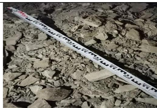
**Рис.1.6. Гранулометрический состав взорванной горной массы при применении разработанного паспорта БВР для сечения выработки 10,36 м<sup>2</sup>.**
