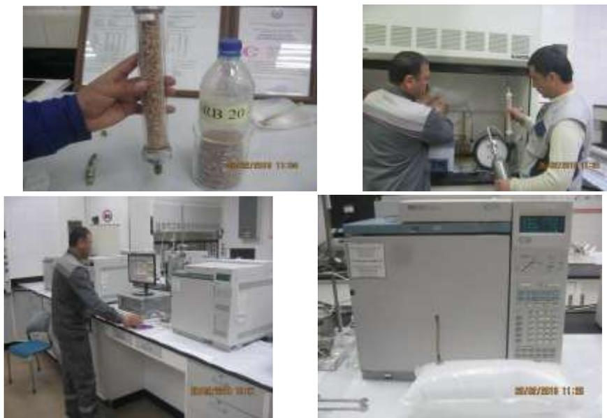
Испытания свежего и регенерированного цеолита РК-38 с диаметром гранул 1/16 проводились в сравнении свежего и регенерированного UzSORB-20.
