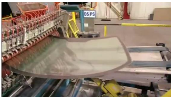
2-rasm. Avtomatik liniyada vakuumlash jarayoni
