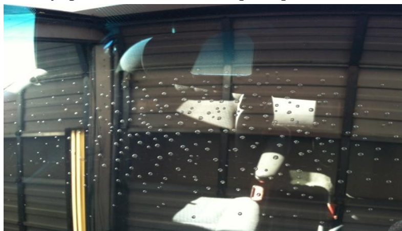
4-rasm. Vakuumlashda havoni yaxshi so‘rilmagandagi hosil bo‘lgan nuqsonlar
