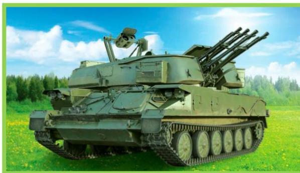
**Рис.1. Зенитно-самоходная установка ЗСУ-23-4 «Шилка» с тепловизором**
