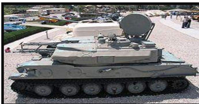
**Рис. 5. Антенна РЛС поднята в рабочее положение**
