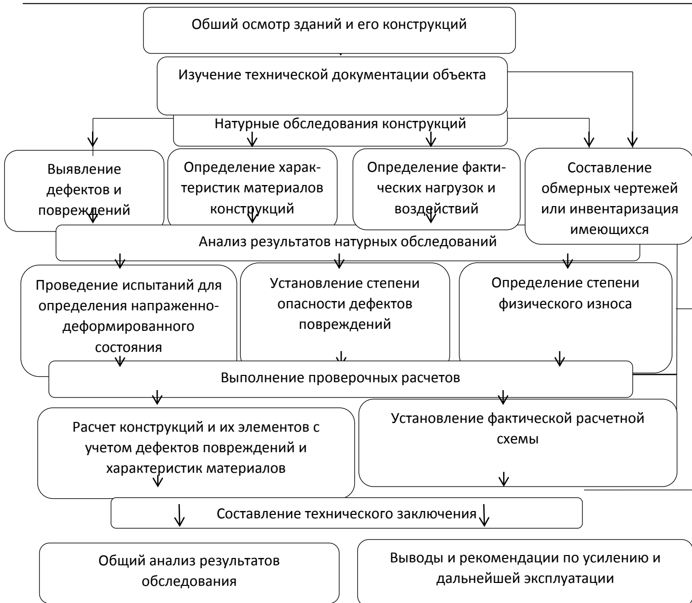
Рис. 2. Последовательность работ по обследованию конструкций зданий.
